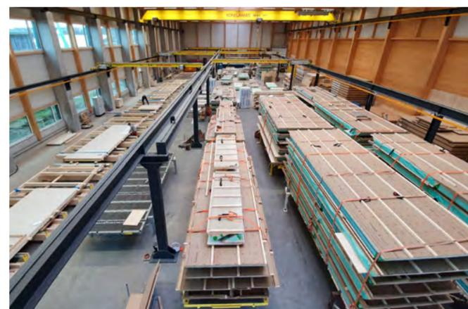
Blick in das Werk 2, wo Bauteile montagebereit vorgefertigt werden.
