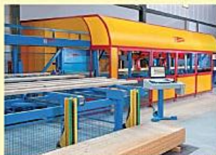
Abbundanlage Hundegger K2i-1250 mit Robot
